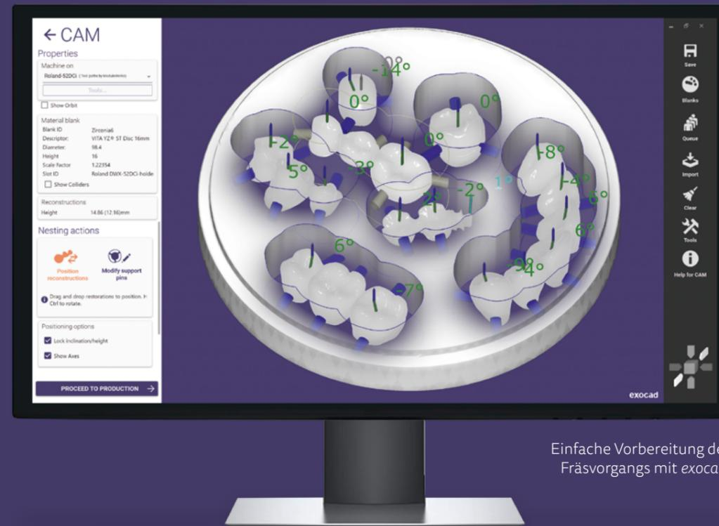
Einfache Vorbereitung des Fräsvorgangs mit *exocam*
